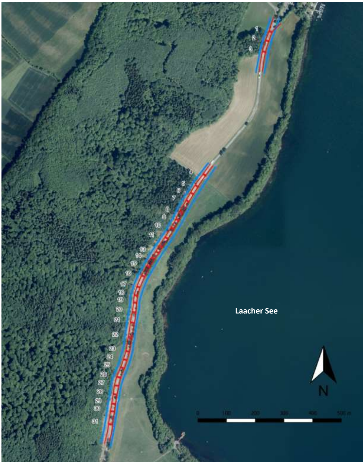
Strecke der Amphibienleitanlage an der L113 und Lage der 31 Amphibientunnel.
