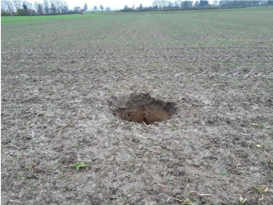
Offener Schacht einer Mergelgrube nördlich von Pulheim-Geyen
